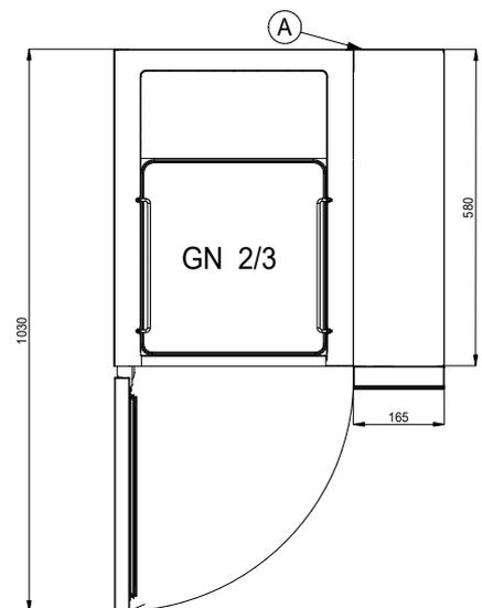
**A.** Cavo di alimentazione di 3,20 m con presa Schuko.
